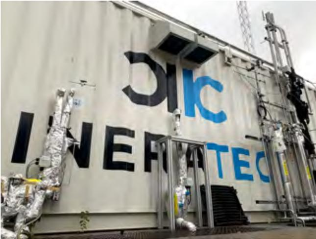
Power-to-X Reaktor in Container-Größe im Energy Lab 2.0 des Karlsruher Institut für Technologie, hier von der Firma Ineratec.
